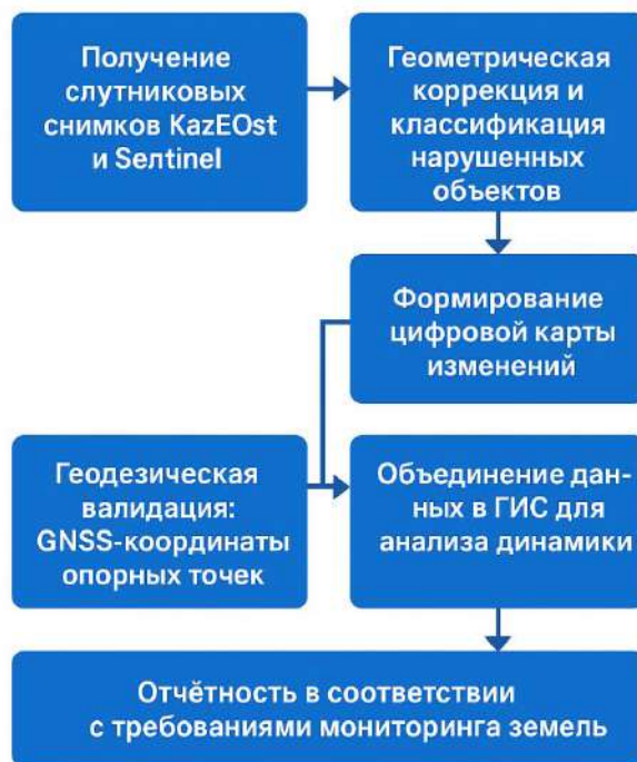
1-сурет - Геодезиялық және аэроғарыштық деректерді интеграциялау схемасы
